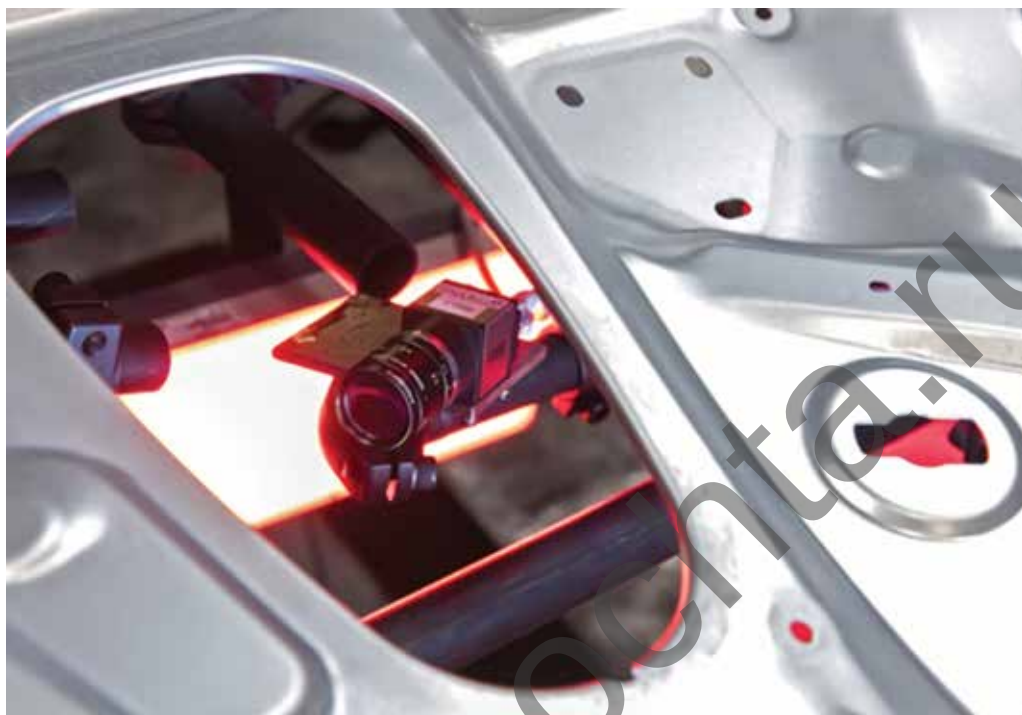
Рис. 6. Камера системы контроля качества работы пресса Audi. Фото из открытых источников
