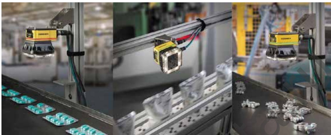
Рис. 4. Камеры контроля качества на производственных линиях. Фото из открытых источников
